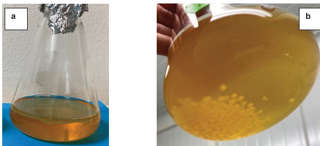
Obr. 4. Foto: Příprava BNC: a) statická kultivace; b) kultivace se třepáním (snímky autorky). (Barevná verze obrázku je dostupná na webových stránkách časopisu Chem. listy).
