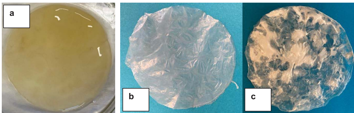
Obr. 5. Foto: a) „nevysušená“ BNC čerstvě vytažená z kultivačního média; b) BNC sušená na vzduchu; c) lyofilizovaná BNC (snímky autorky). (Barevná verze obrázku je dostupná na webových stránkách časopisu Chem. listy).
